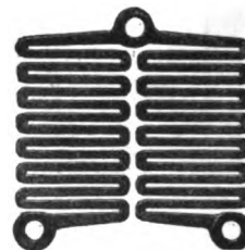
Fig. 1747—Grid Resistor Unit
